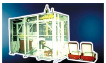
Anlage mit Chargenzentrifugen
